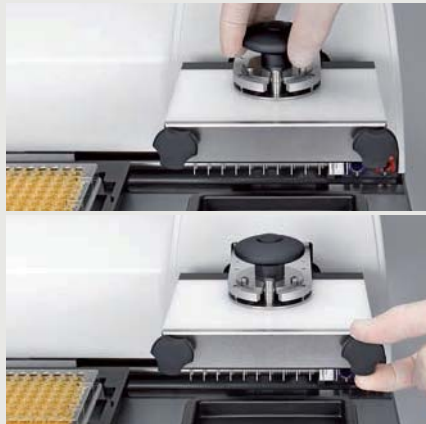
洗浄ヘッドは工具不要で迅速に着脱できるため取り扱いが容易
