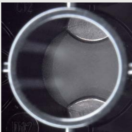
各ウェルに2個の磁石を配置し回収率を最大化
